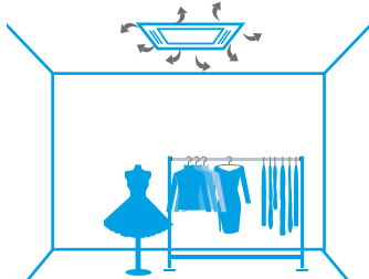
Rozkład powietrza z zabrudzonym filtrem
