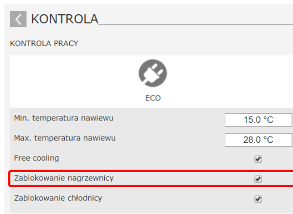
Rys. 1 Blokada nagrzewnicy w trybie ECO
